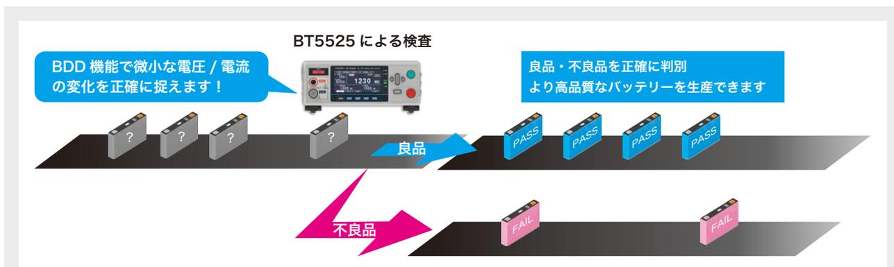
BT5525 の BDD 機能で、微小な電圧や電流の変化を正確に捉えることができます。良品と不良品を正確に判別することで、波形計測におけるデータ取りこぼしが防げます。正確な検査により高品質のバッテリーが生産できます。
