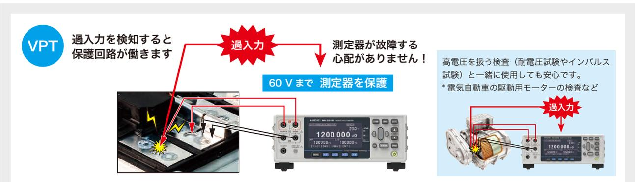
VPT は 60 V までの耐電圧と過入力電圧を監視する機能です。電圧が発生しているバッテリーパックのバスバーを測定する場合に、測定器の故障を気にせず可以使用です。過入力を検知すると保護回路が働き、即座に測定を停止します。過入力が無くなれば、自動的に測定を再開します。
