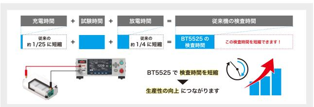
BT5525 では最大 50 mA で充電し、定電流で放電するため、充電と放電の時間が短縮できます。 また、現在運用している判定基準(抵抗値)までの到達時間が早くなるため、**設定している試験時間を短縮できる可能性があります。**
