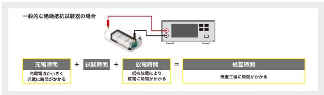
一般的な絶縁抵抗試験器は充電電流が小さく、容量の大きな被試験物に対して充電時間がかかってしまいます。 また、放電も抵抗放電によるものが多く、放電に時間がかかってしまうことが多いです。
